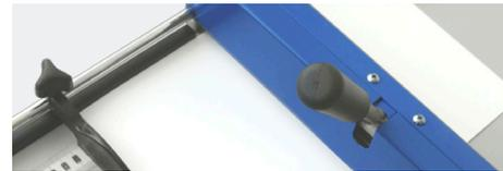
Su uso es muy sencillo, se coloca el papel en la posición de plegado ajustándolo con ambas guías de alineación. Con un movimiento firme y fuerza moderada se empuja la palanca hacia abajo, el papel quedará marcado y podremos retirarlo para colocar la siguiente hoja.
